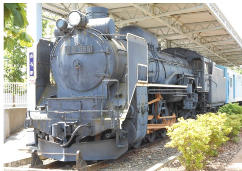
設置から25年が経過しサビが目立つ機関車
